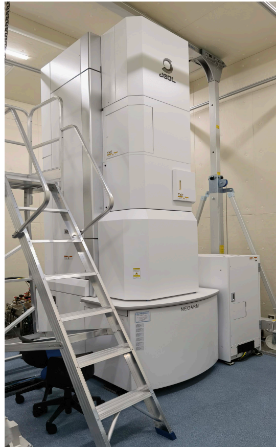
安装在日本岛根大学的国际上首台商业化无磁场透射电子显微镜
